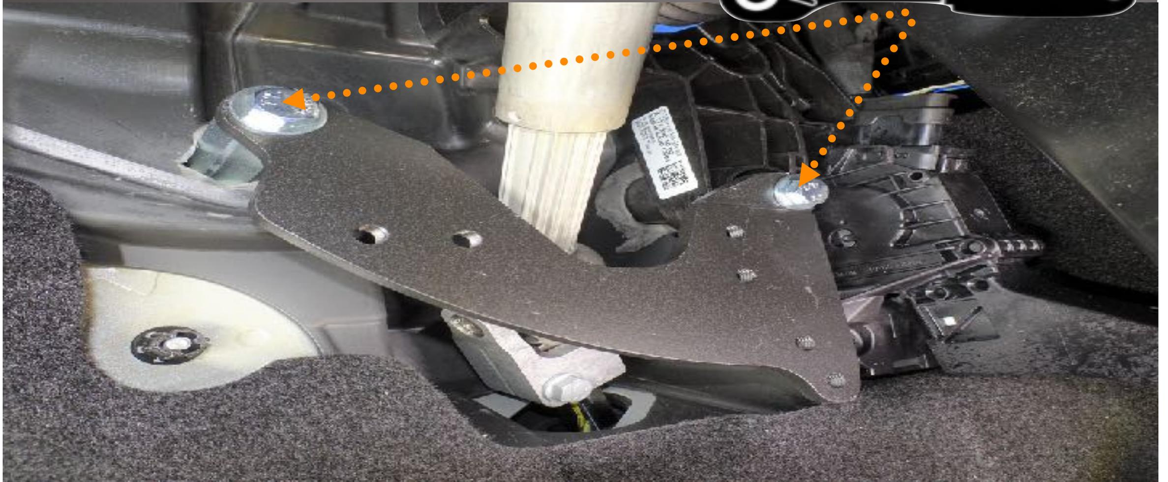
Entfernen Sie die Verbindungsmutter
